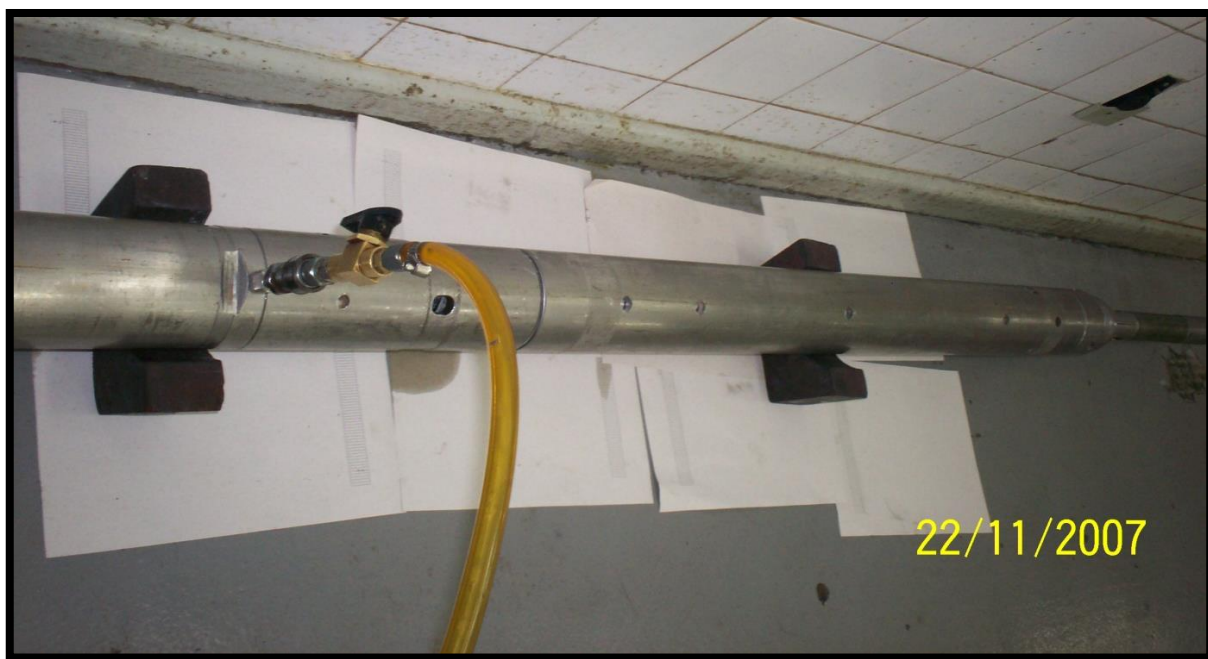
Figura 6 – Procedimento de completa do óleo compensador
