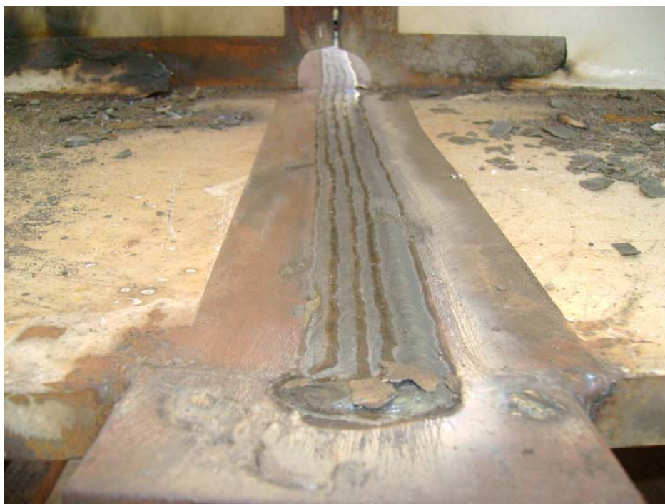
Figura 5.11 – Remoção de escoria após a finalização da solda.
