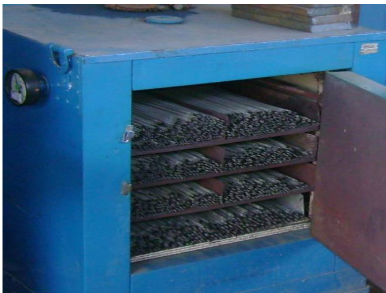
Figura 5.7 – Estufa para ressecagem dos eletrodos
