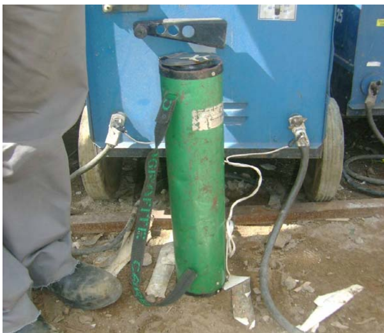
Figura 5.8 – Estufa portátil para armazenamento dos eletrodos (“cochichos”)
