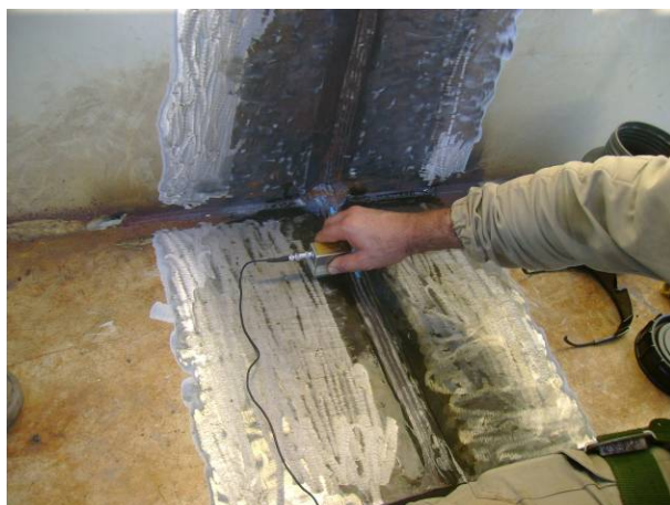
Figura 5.17 – Realização do ensaio de Ultra-Som
