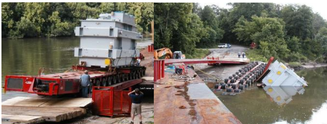
Figura 4.1 – Acidente no transporte de transformador de grande porte
