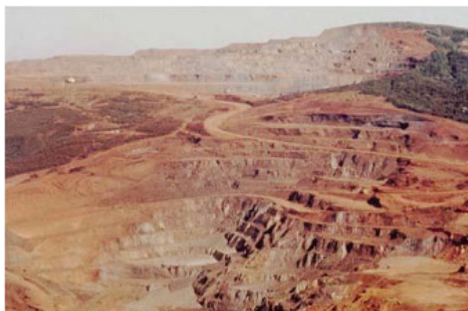
Figura 2.2 – Jazida de minério de ferro evidenciando a profundidade de extração e a influência no meio ambiente.
