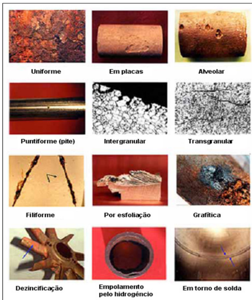
Figura 2.3 – Formas de corrosão.
