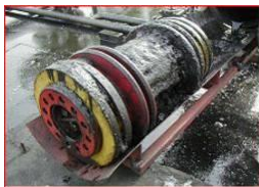
Figura 14 - Pig Magnético Após Utilização
