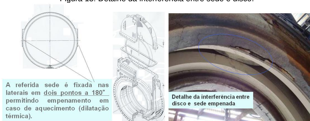
Figura 15: Detalhe da interferência entre sede e disco.
