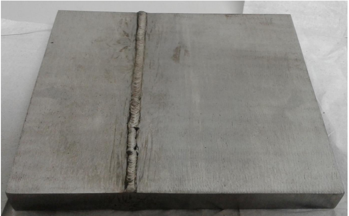
Figura 15: Amostra de aço A-36 com junta de solda (parte inferior)
