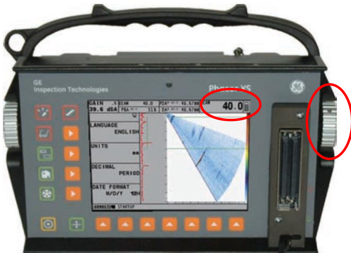
Figura 23: Indicação na tela e cursor do ângulo da varredura (Beam)
