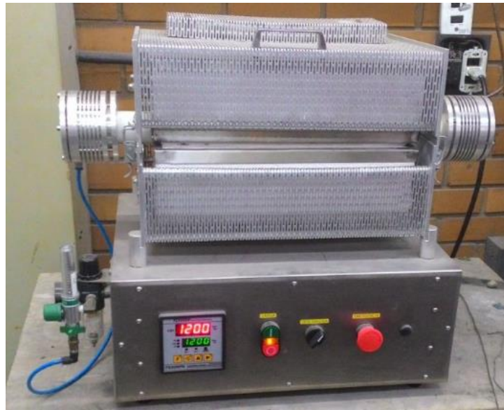
Figura 24 - Forno tubular horizontal utilizado no tratamento de solubilização.
