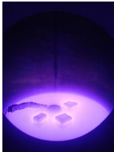
Figura 26 - Amostras durante tratamento de Nitretação no reator
