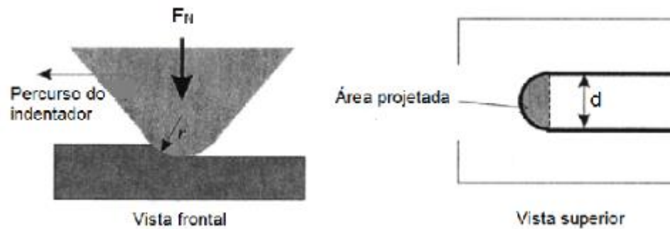
Figura 22 - Ilustração do contato durante o ensaio de esclerometria.
