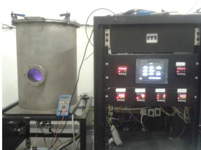
Figura 25 - Equipamento utilizado no tratamento de nitretação a plasma.
