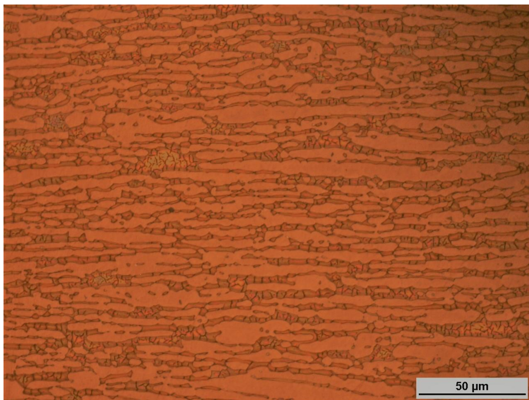
Figura 32. Micrografia da amostra A14 da região não aquecida. Ataques eletrolítico com NaOH.
