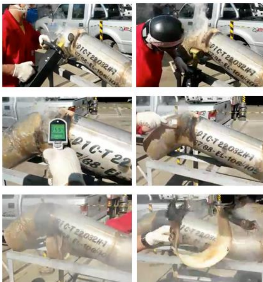
Figura 8. Sequência de remoção do vedante polimérico.
