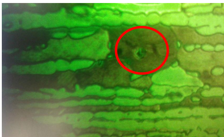
Figura 35. Indentação do ensaio de microdureza Vickers na fase ferrítica para carga de 10gf.
