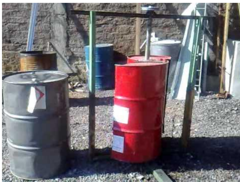
Figura 15 - Turbina Savonius feita de tonel
