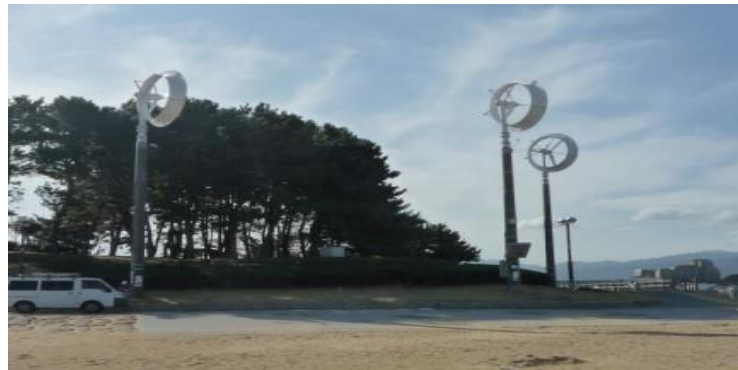
Figura 20 - Turbina com a lente eólica (OHYA, 2014)
