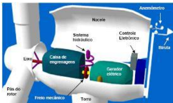
Figura 4 - Esquema da nacele de uma turbina eólica de eixo horizontal
