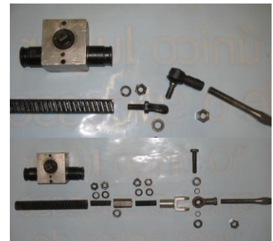
Figura 09 Comparação entre as fixações do braço oscilante
