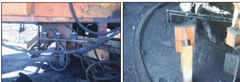
Figura 43 - Sensor e Atuador da Mesa de Giro do DN04
