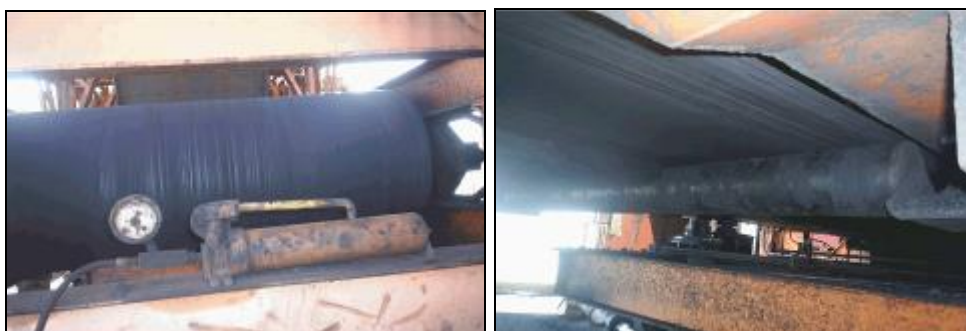
Figura 44 - Polia e Correia do Alimentador do DN05
