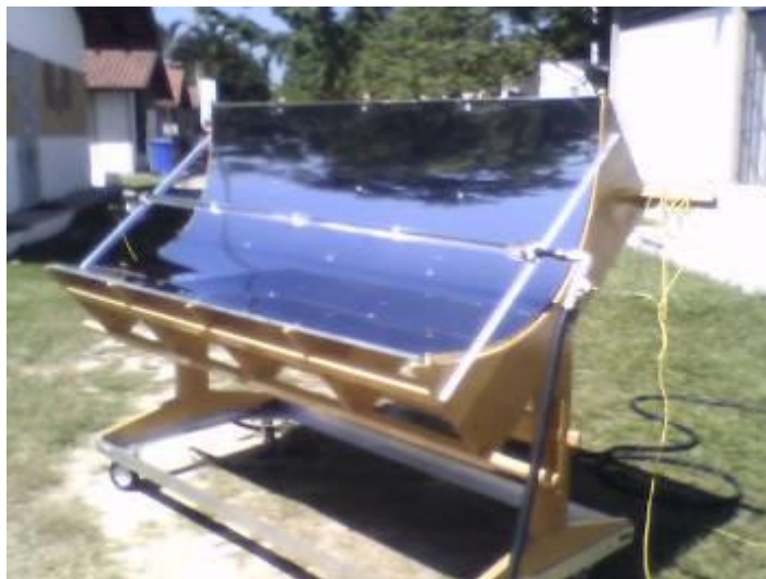
Figura 24 – Teste do tubo focal envolto em um tubo de vidro
