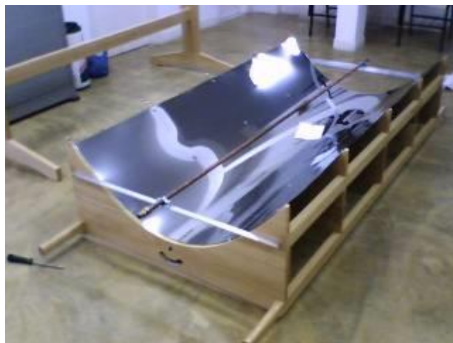
Figura 14 – Fixação do tubo focal através de cantoneiras de alumínio.
