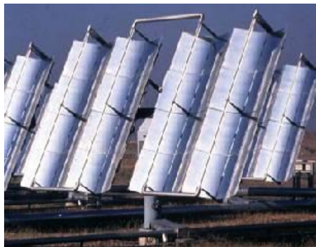
Figura 6 – Concentrador solar articulado em dois eixos
