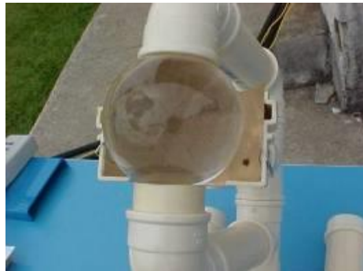
Figura 32 – Detalhe da esfera de vidro do heliógrafo
