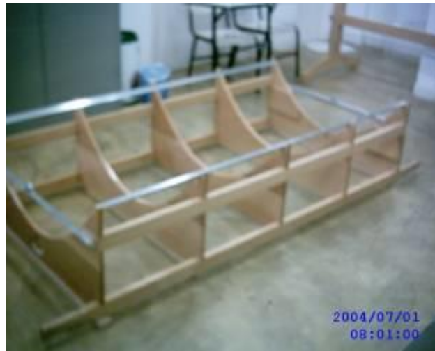
Figura 12 – Estrutura com cantoneiras de alumínio.
