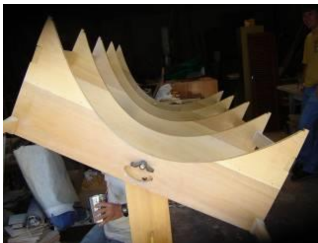
Figura 10 – Placas laterais confeccionadas com auxílio do molde.
