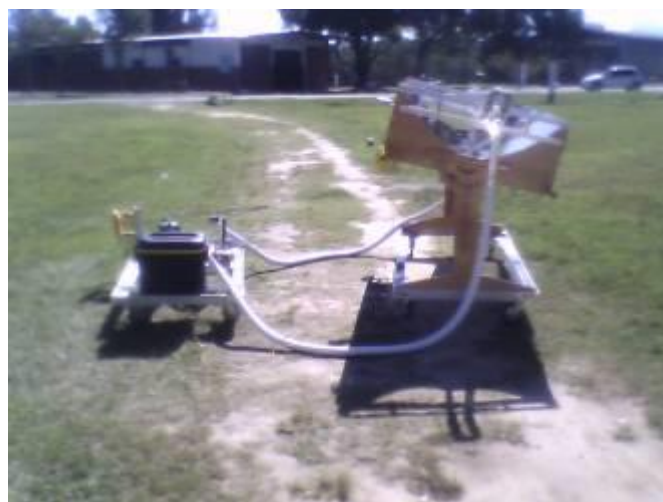
Figura 26 – Teste do concentrador solar operando em circuito fechado
