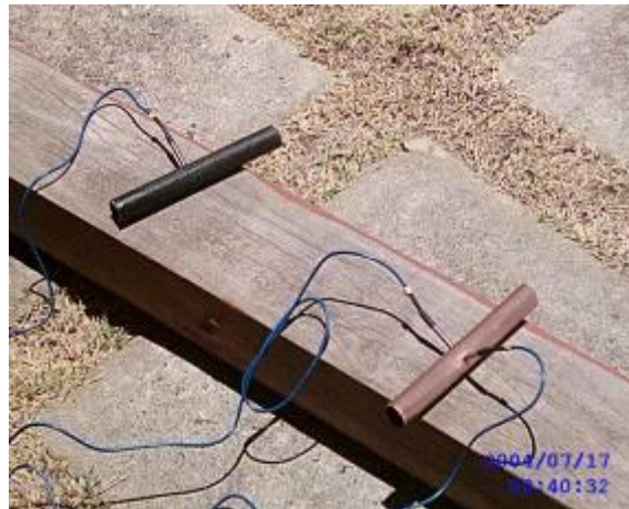
Figura 27 - Experimento para seleção do acabamento superficial do tubo coletor focal.
