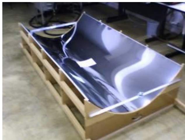
Figura 13 – Acomodamento da superfície refletora sobre o berço.
