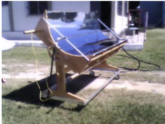
Figura 18 – Concentrador solar em teste, já instalado sobre a base móvel.
