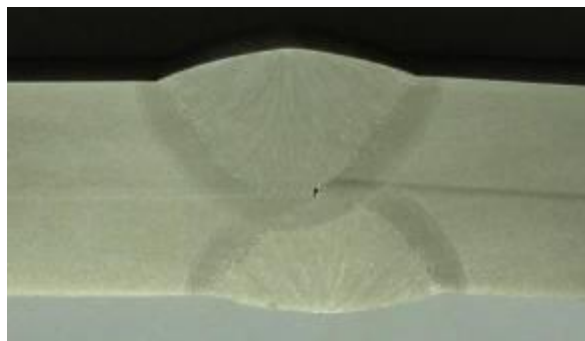
Figura 15 – Macrografia da junta solda confeccionada com o metal base ASTM A-36.
