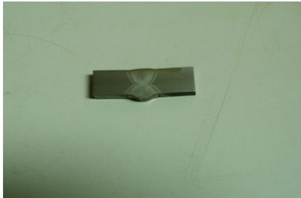
Figura 16 – Macrografia da junta solda confeccionada com o metal base API 5L X60.
