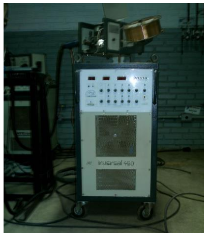
Figura 7 – Fonte de energia INVERSAL 450 utilizada para a realização das soldagens
