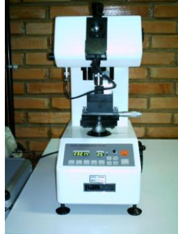
Figura 12 – Microdurômetro utilizado para os ensaios de microdureza
