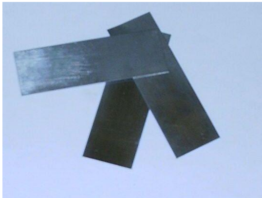
Figura 5 – Chapas comerciais fabricadas em aço inoxidável duplex AISI 2205 utilizadas nos experimentos
