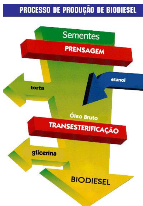
Figura 2: Forma esquemática de representação do processo de produção do Biodiesel
