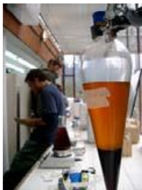
Figura 4: Biodiesel e glicerina separados por diferença de densidade.
