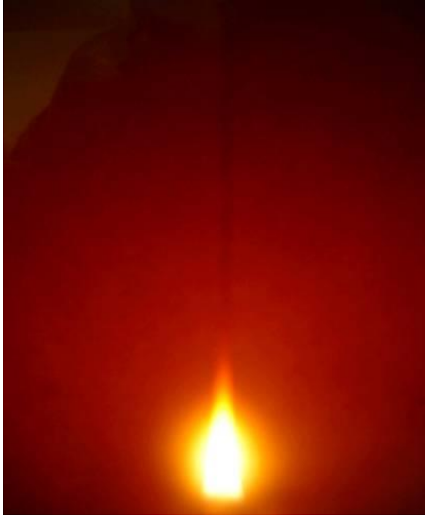
Figura 3.3.1 – Chama laminar, oriunda da combustão de querosene, com o filete de emissões.
