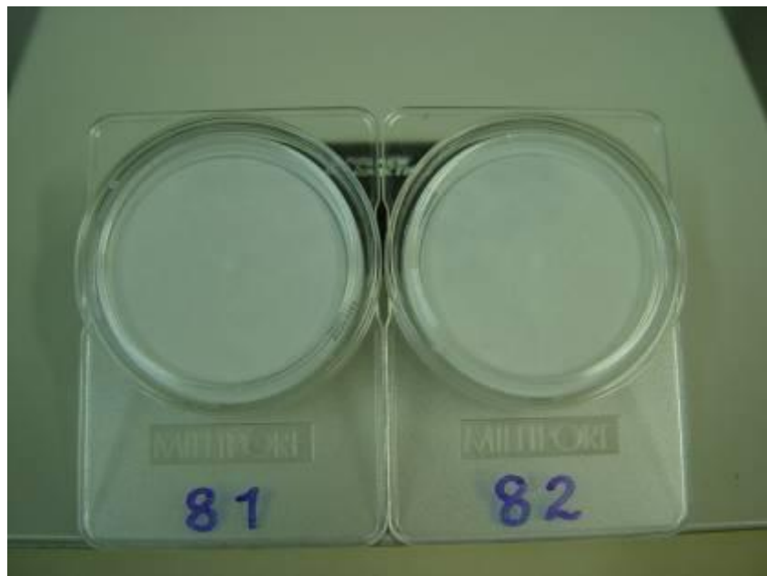
Figura 3.3.3 – Filtros de Teflon, expostos durante 10"04 e 13"19.
