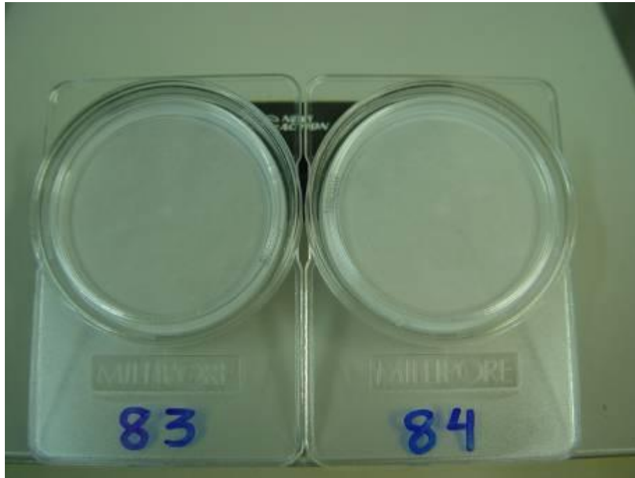
Figura 3.3.4 – Filtros de Teflon, expostos durante 16"25 e 19"39.
