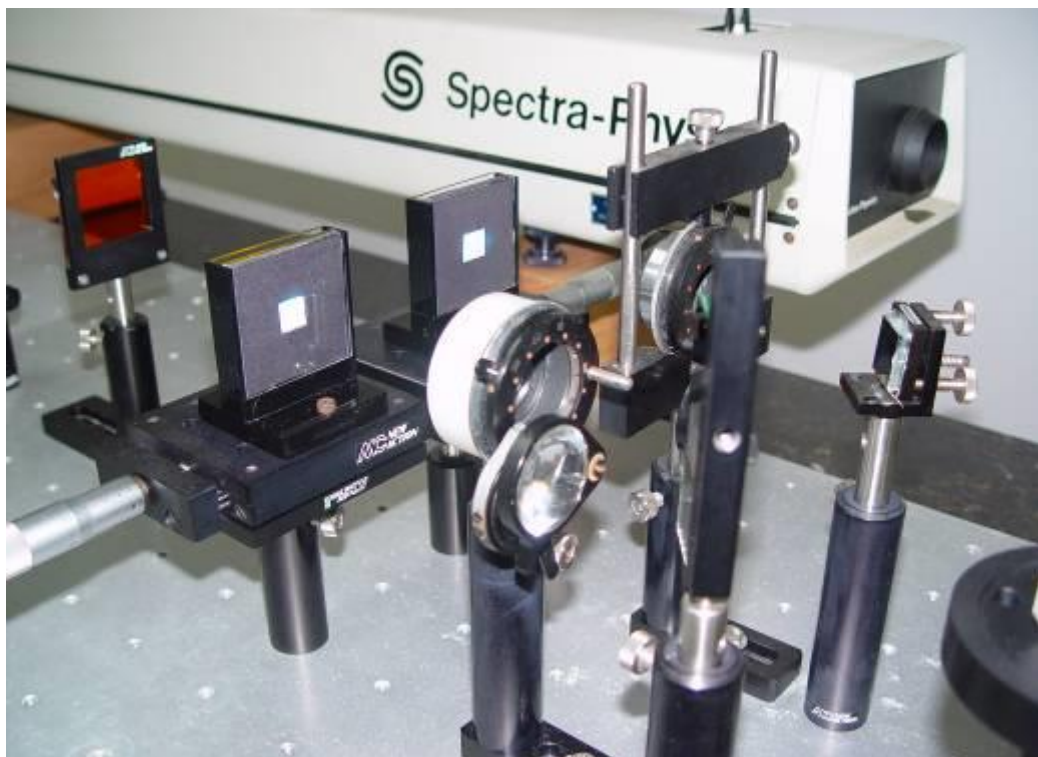
Figura 3.2.4 – Detalhe do sistema óptico utilizado para geração e captura de imagens, mostrando as células com os filtros.
