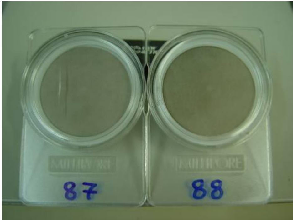
Figura 3.3.6 – Filtros de Teflon, expostos durante 27"09 e 29"95.
