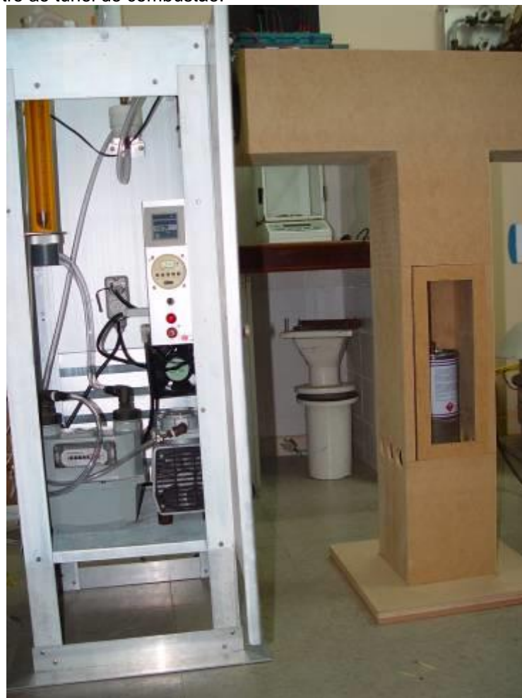
Figura 3.1.2 – Aparato de coleta, mostrando um amostrador de PM 2,5 à esquerda e o túnel de combustão, em madeira.
