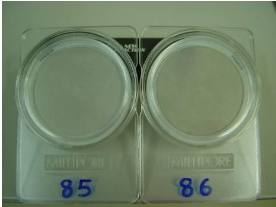
Figura 3.3.5 – Filtros de Teflon, expostos durante 21"45 e 24"29.
