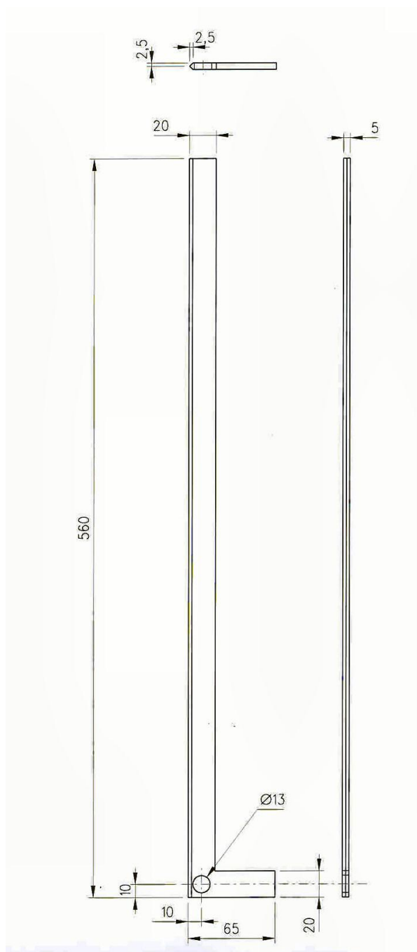
Ilustração 25: desenho de projeto - barra em L
