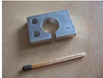
Ilustração 17: corpo da célula de carga usinado
