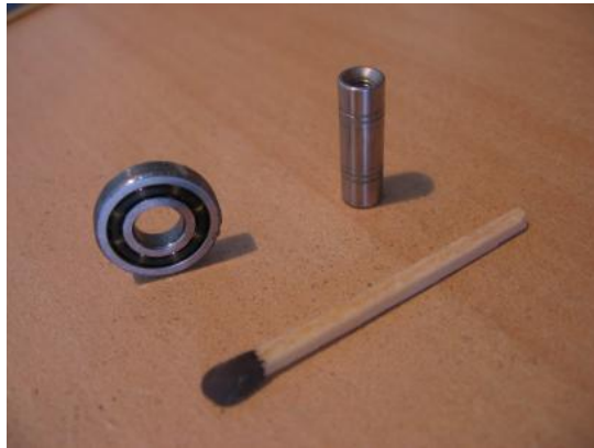
Ilustração 4: eixo e rolamento de HD
