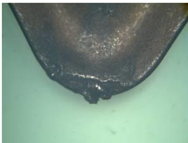
FIGURA 43 - Aresta da pastilha T2015 após usinar 515 mm.
