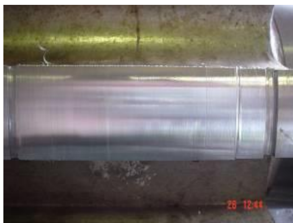
FIGURA 41 - Superfície mostrando quebra logo no início da pastilha T2015 usinando com profundidade 100% maior
