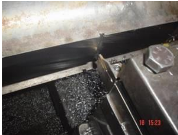
FIGURA 18 – Abertura de rasgo com Bedame
