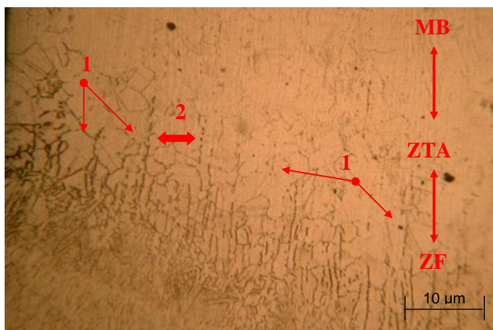
Figura 23 - Energia de soldagem 1,4 kJ/cm: o índice (1) representa ilhas de precipitados isoladas, o índice (2) representa as bandas de deformação como local preferencial de precipitação.
