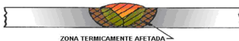
Figura 6 - Zona termicamente afetada (ESAB, 2004).
