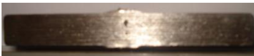
Figura 22 – Soldagem numa junta de topo com chanfro em X.
