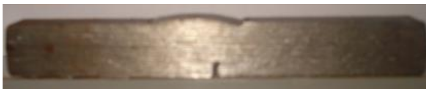
Figura 23 – Soldagem numa junta de topo com chanfro em V – Parâmetros inadequados.
