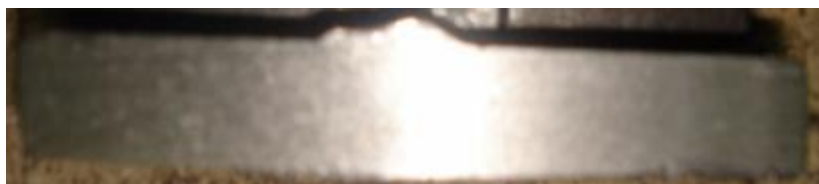
Figura 24 - Soldagem numa junta de topo com chanfro em V – Parâmetros adequados.
