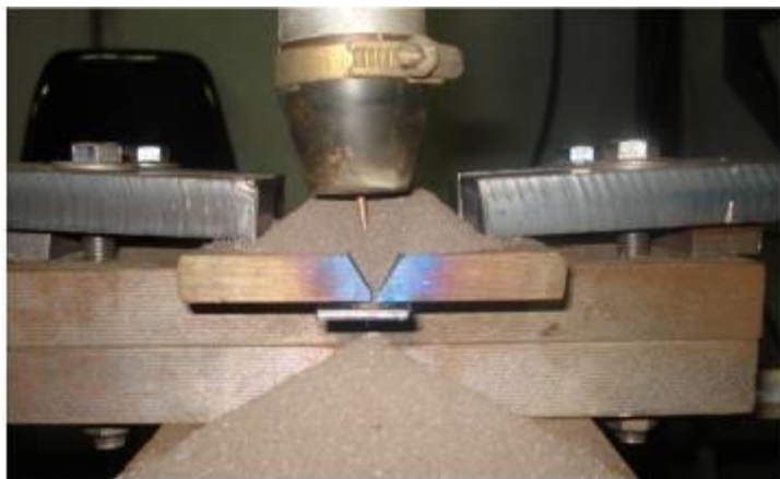
Figura 18 – Dispositivo de fixação do corpo de prova.
