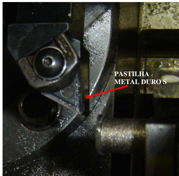
Figura 3.3 – Pastilha TNMG 160408-23 1105 – classe: metal duro S.
