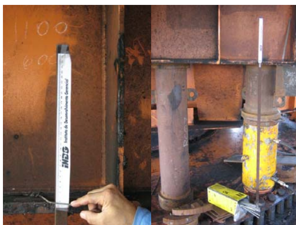
Figura 4.15 – Régua para o controle da elevação da estrutura.
