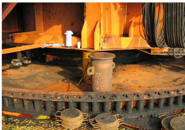
Figura 4.14 – Instalação das bases de sustentação com acionamento hidráulico para elevação da estrutura superior do equipamento.
