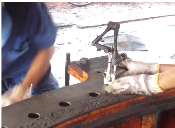
Figura 4.18 – Teste de planicidade do leito do rolamento. Fonte: Registros fotográficos do projeto, CVRD (2007).
