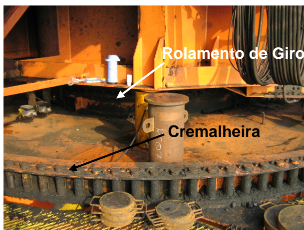
Figura 3.14 – Cremalheira externa do sistema de giro e rolamento de giro da Recuperadora de Carvão.
