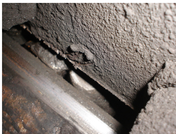
Figura 4.1 – Rolos danificados e indícios de lubrificação insuficiente. Fonte: Relatório de Inspeção da Recuperadora RC07, SILVA (2005).
