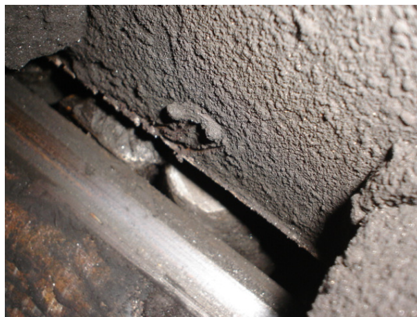
Figura 4.3 – Rolos com indícios de deformação plástica e perda do espaçamento.
