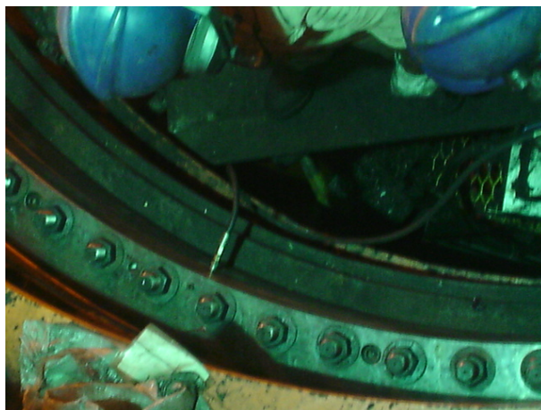
Figura 4.25 – Lubrificação do rolamento de giro.
