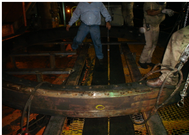
Figura 4.17 – Retirada do rolamento danificado. Fonte: Registros fotográficos do projeto, CVRD (2007).
