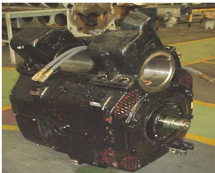
Figura 35 - Motor de Tração Fonte: VALE, BORBA, J. L., 2007
