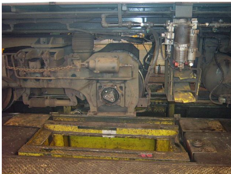
Figura 50 - Locomotiva sob a mesa falsa Fonte: Acervo da Vale
