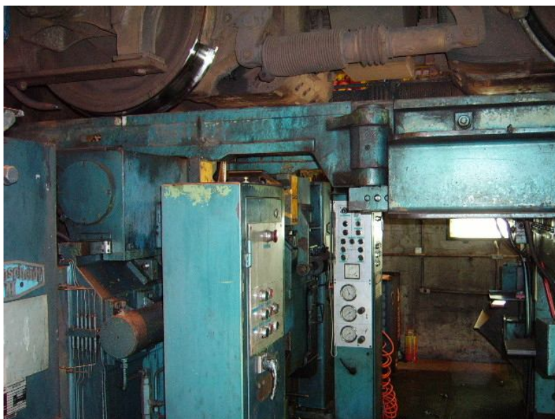
Figura 47 - Locomotiva posicionada sob o torno Fonte: VALE, BORBA, J. L., 2007
