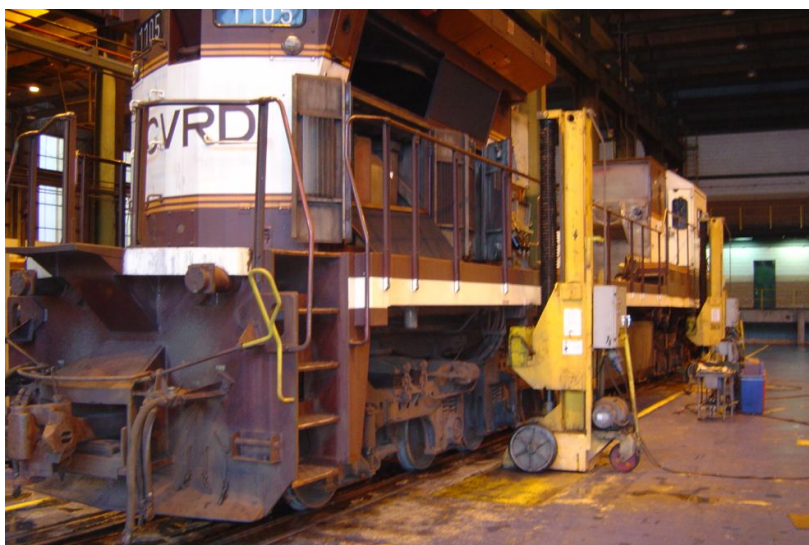
Figura 48 - Locomotiva se preparando para ser suspensa nos macacos Fonte: VALE, BORBA, J. L., 2007
