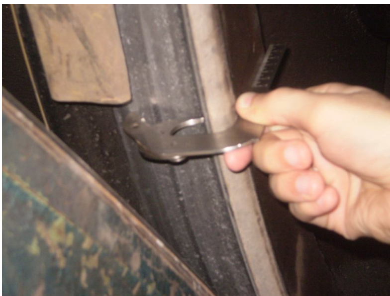
Figura 54 - Operador efetuando medição do rodeiro
