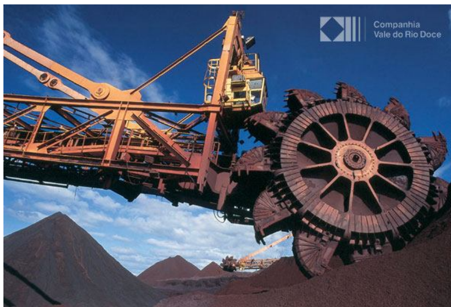
Figura 2 - Recuperadora de minério de ferro em Tubarão – ES Fonte: Acervo da VALE
