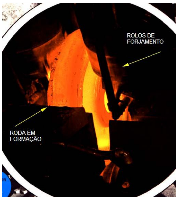
Figura 39 - Processo de Forjamento de Roda Fonte: ROSA, 2006
