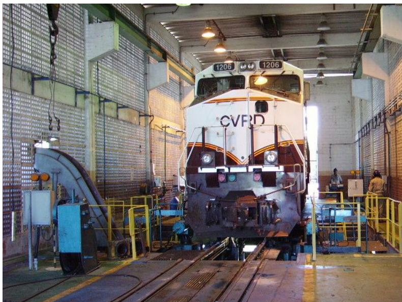
Figura 46 - Locomotiva no Torno de Rodas Fonte: VALE, BORBA, J. L., 2007
