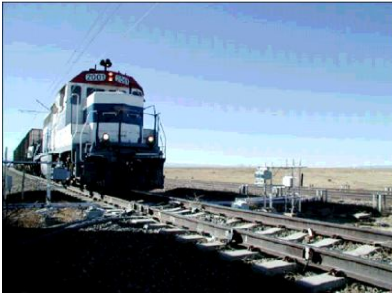
Figura 59 - Sistema de Monitoramento de Sapatas de Freio e Perfis de Rodas Fonte – LUNDGREN
