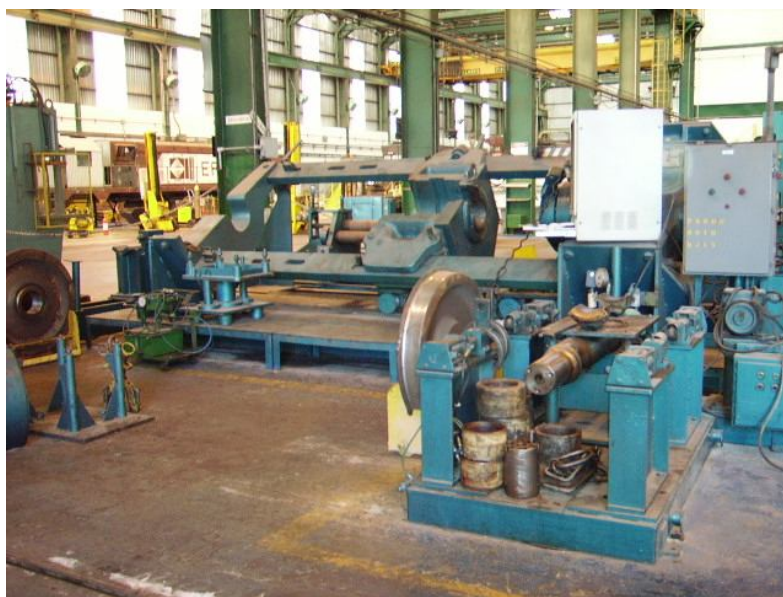
Figura 49 - Máquina de eixamento Fonte: Acervo da Vale
