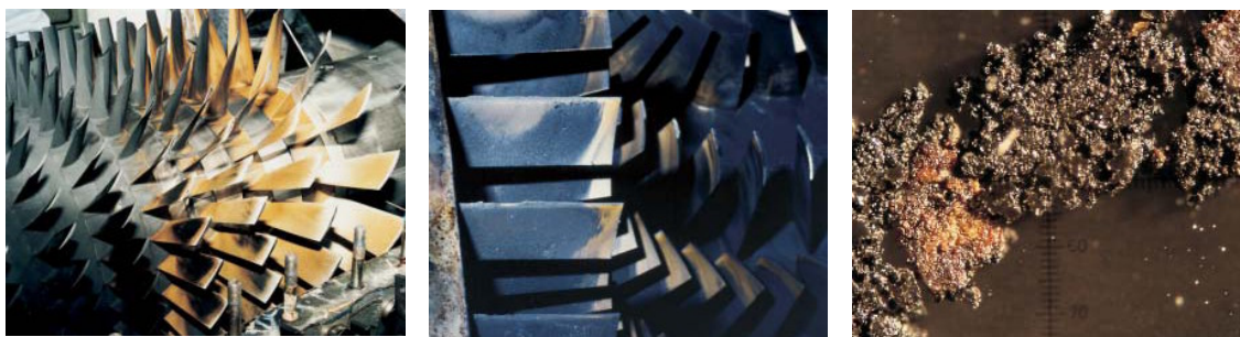
Figura 2.14: Pás do compressor danificadas devido a choques com particulados do ar. Fotografia aumentada mostrando detalhe de corrosão nas pás do rotor.
