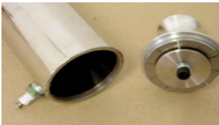
Figura 34 – Detalhe do difusor desencaixado da câmara de combustão. Fonte: MANUAL PULSOJATO. < http://www.foguete.org/silverjet/manual.pdf >.
