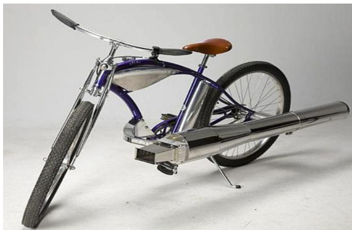
Figura 40 - Esquema de bicicleta com motor pulso jato.
