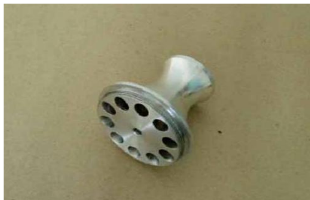
Figura 36 – Difusor, peça única de alumínio usinada em CNC. Fonte: MANUAL PULSOJATO. < http://www.foguete.org/silverjet/manual.pdf >.
