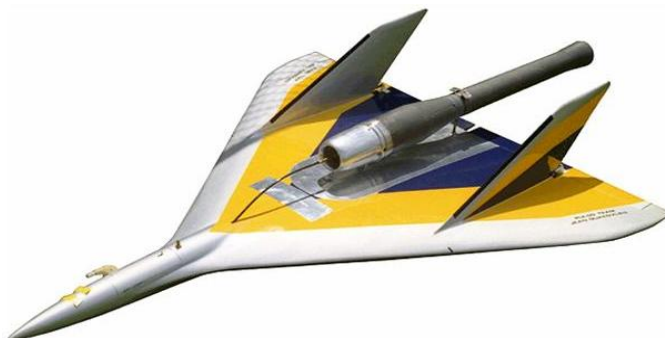
Figura 39 - Esquema de Aeromodelo com motor pulso jato integrado.
