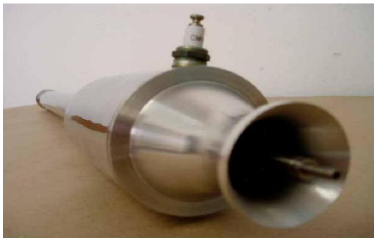
Figura 33 – Detalhe frontal do difusor, injetor de combustível e vela de ignição. Fonte: MANUAL PULSOJATO. < http://www.foguete.org/silverjet/manual.pdf >.
