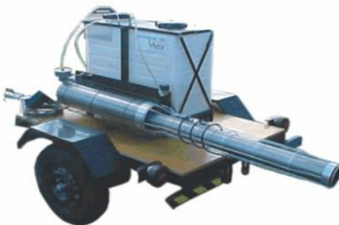
Figura 44 - Montagem de um termonebulizador com motor pulso jato.
