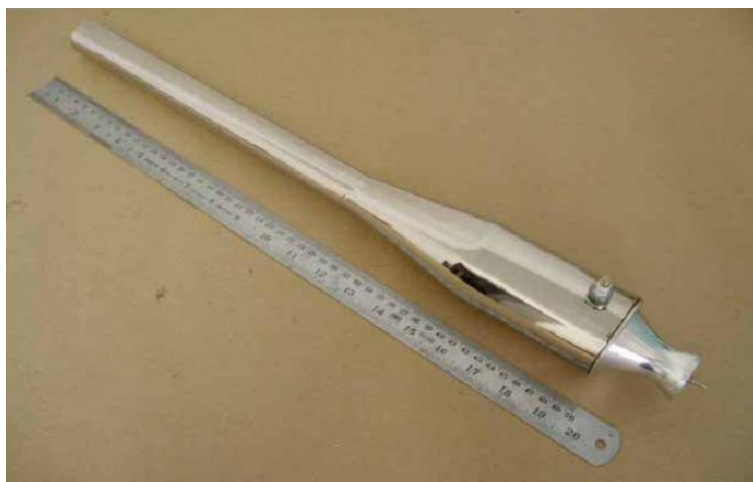
Figura 32 – Exemplo de montagem de um pulso jato ( 65 mm x 560 mm ).
