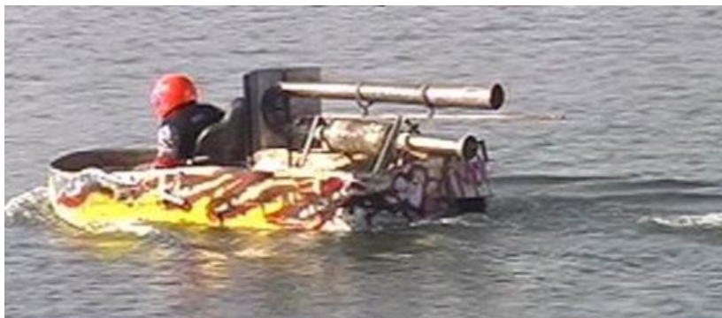
Figura 43 - Esquema de barco com motor pulso jato integrado.
