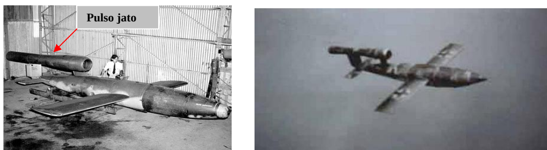
Figura 7 - Fotos reais de um míssil V-1 “Buzz Bomb” parado (esquerda) e em vôo (direita) Fonte: Experimental Investigations in 15 Centimeter Class Pulsejet Engines.
