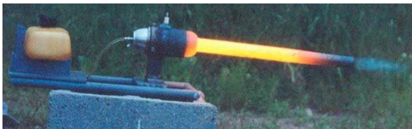
Figura 29 - Ilustração de pulso jato em situação de aquecimento excessivo. Fonte: MANUAL PULSOJATO. < http://www.foguete.org/silverjet/manual.pdf >.
