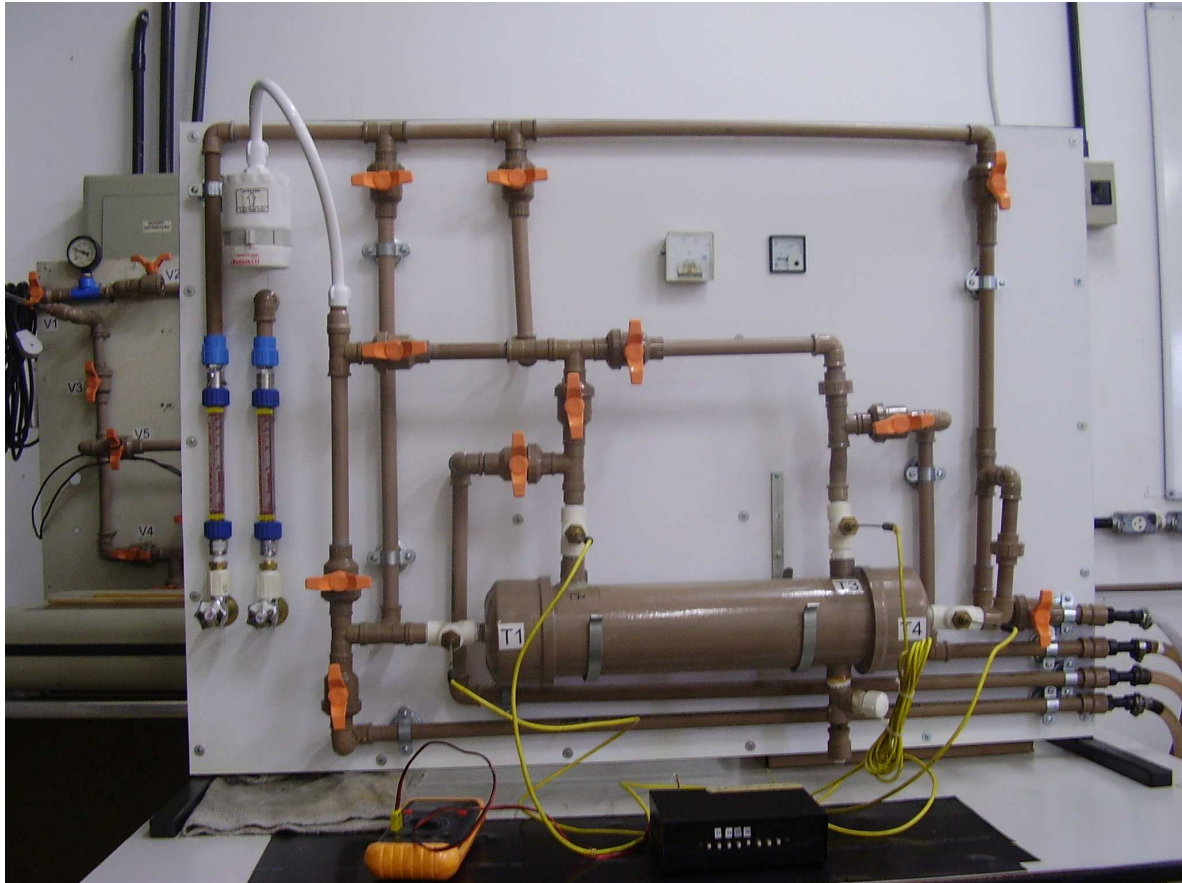
Figura 17 – Nova bancada de ensaio para o trocador de calor.
