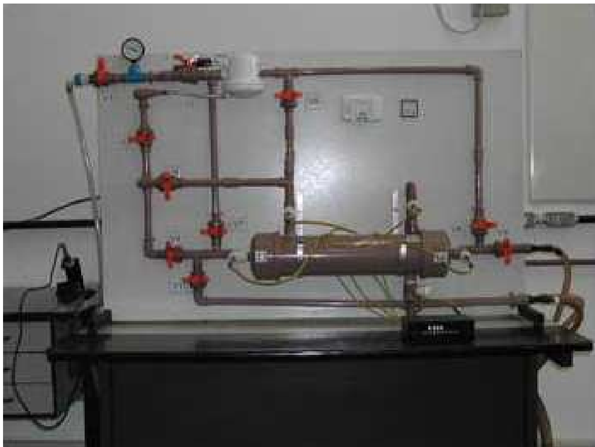
Figura 16 – Antiga bancada de ensaio para o trocador de calor.
