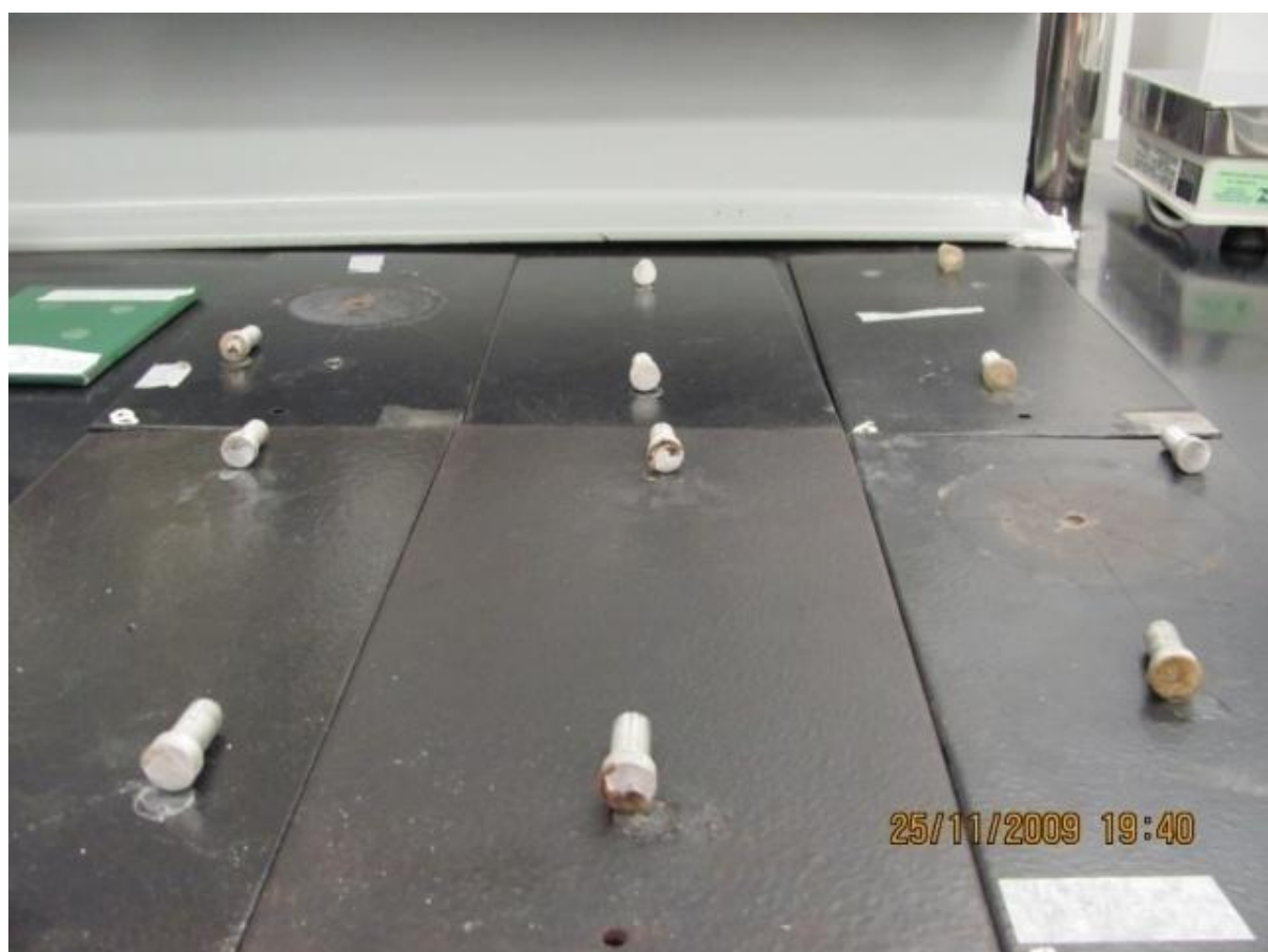
Figura 25 – Realização dos testes de aderência Pull-Off. Parafusos colados à placa (acima) e parafusos após serem arrancados.
