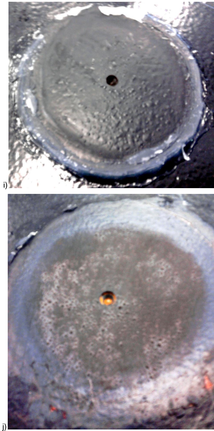
Figura 21 – Aspecto visual do empolamento das amostras após ensaio de Descolamento Catódico. i) Tar-Free; j) Alcatrão de Hulha
