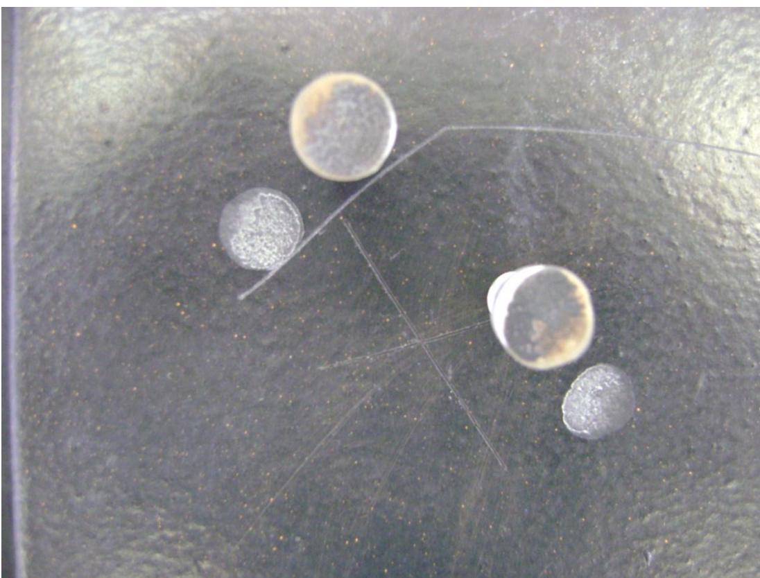
Figura 24 – Corpo de prova nº 12 revestido com tinta Tar Free (m) e corpo de prova nº 06 revestido com Alcatrão de Hulha (n) após ensaio Pull-Off
