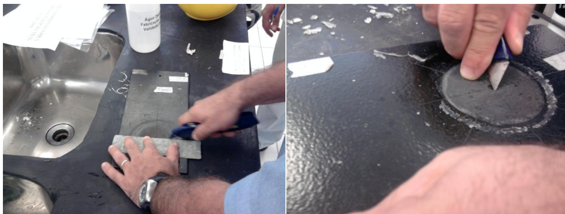
Figura 22 – Cortes para ensaio de arrancamento (à esq.) e o próprio ensaio de arrancamento
