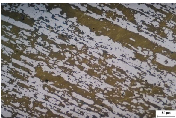
Figura 4.6 - Microestrutura do aço UNS S32304 tratado a 900°C durante 15 minutos
