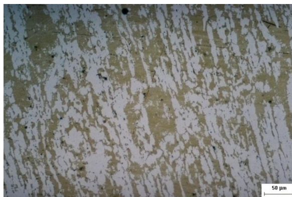
Figura 4.5 - Microestrutura do aço UNS S32304 tratado a 750°C durante 8 horas
