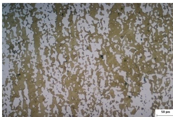
Figura 4.7 - Microestrutura do aço UNS S32304 tratado a 900°C durante 8 horas
