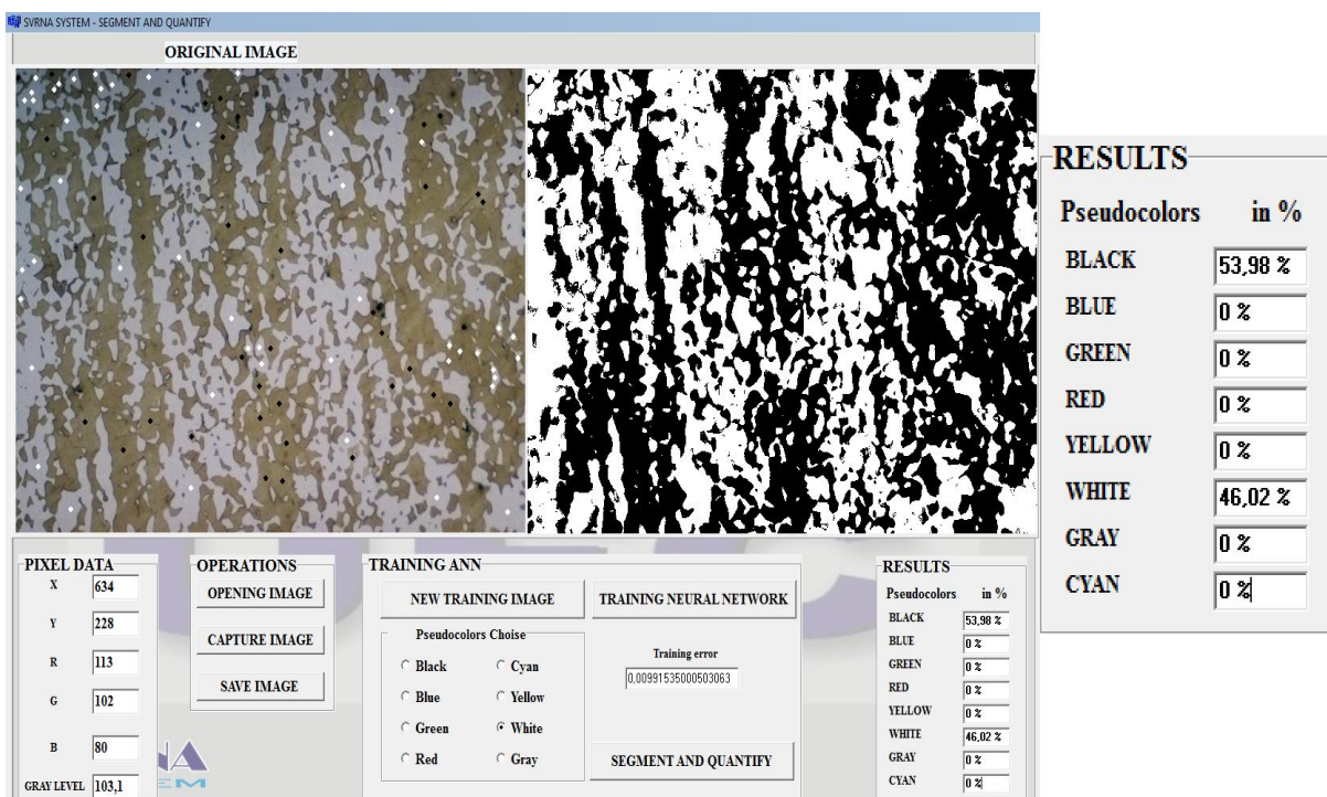
Figura 4.11 - Quantificação de ferrita do aço UNS 32304 tratado a 900°C durante 8 horas
