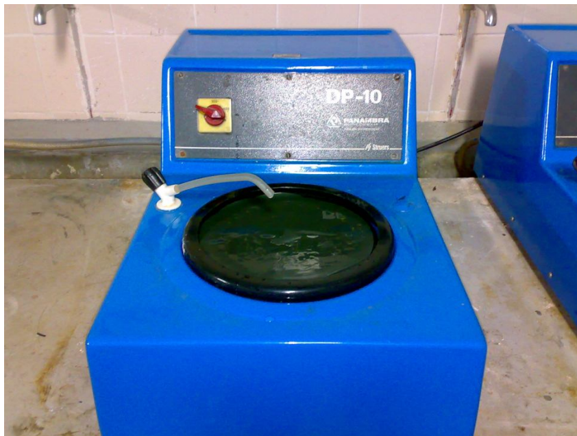
Figura 3.2 - Lixadeira / Politriz pertencente ao laboratório de materiais da UFES
