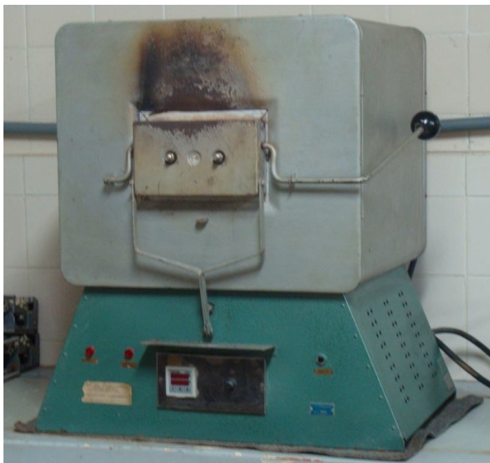
Figura 3.1 - Forno tipo Mufla, pertencente ao laboratório de materiais da UFES
