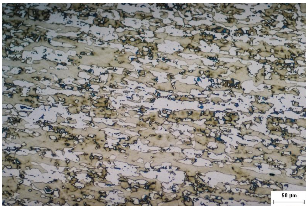
Figura 4.1 - Microestrutura do aço UNS S32304 como recebido
