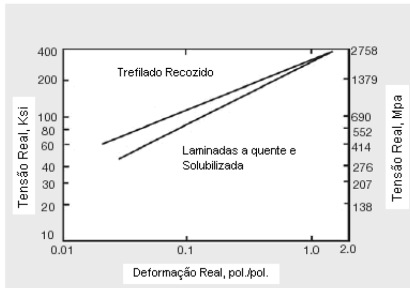
FIGURA 01 – Curva tensão-deformação do Inconel 625 a 25°C [10]
