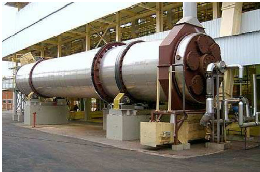
Figura 13 – Secador rotativo. Fonte: TECNAL (apud Zempulski & Zempulski, 2007).
