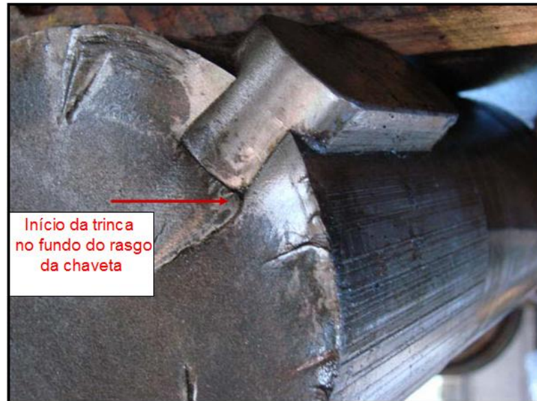
Figura 21 - Eixo da roda livre – Primeira fratura – Presença de trinca por fadiga Iniciada no rasgo da chaveta – Detalhes.
