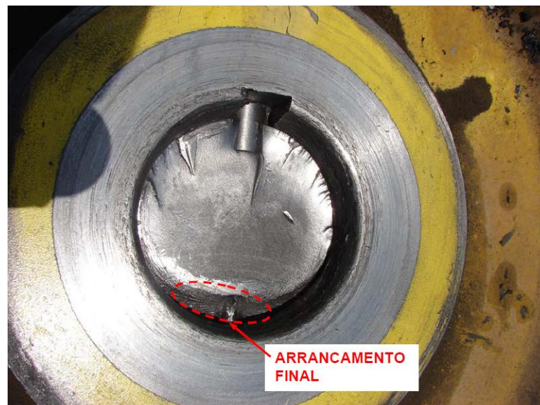
Figura 22 - Eixo da roda livre – Primeira fratura – Iniciação no rasgo da chaveta.
