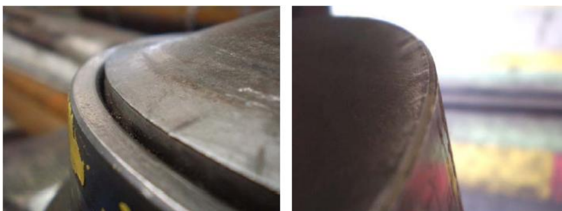
Figura 25 - Eixo da roda livre – Segunda fratura – Raio de concordância de 1 mm no projeto – Regiões de nucleação de trincas por fadiga.
