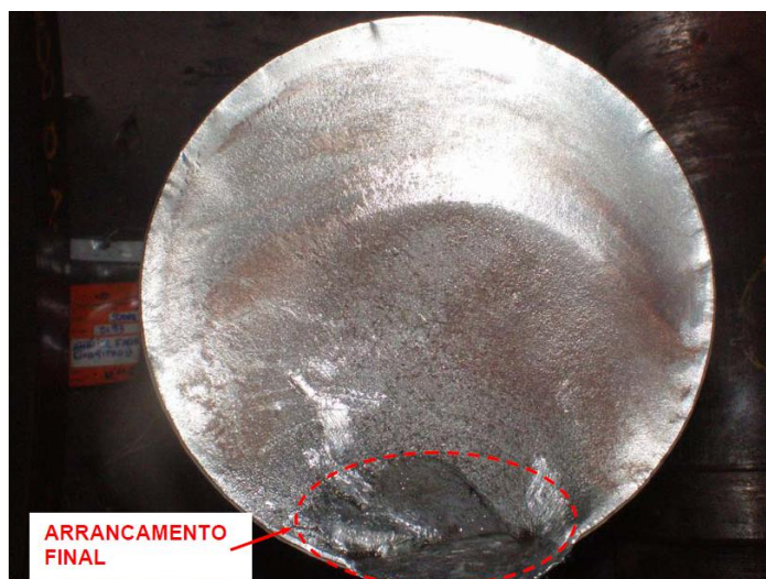
Figura 24 - Eixo da roda livre – Segunda fratura – Presença de trinca por fadiga iniciada na mudança de seção.
