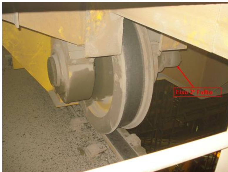
Figura 20 - Conjunto Eixo-Roda Livre da 2ª Falha – Translação do Carro da Ponte Fonte: Arquivo ArcelorMittal Tubarão, 2010.
