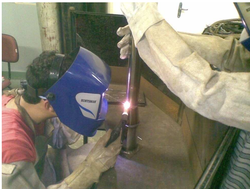
Fotografia 6 - Processo de soldagem do tubo de exaustão dos gases.
