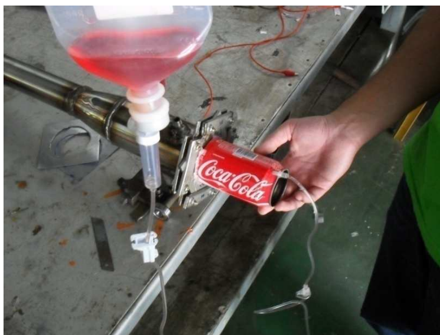
Fotografia 18 - Sistema de injeção de gasolina com difusor improvisado.
