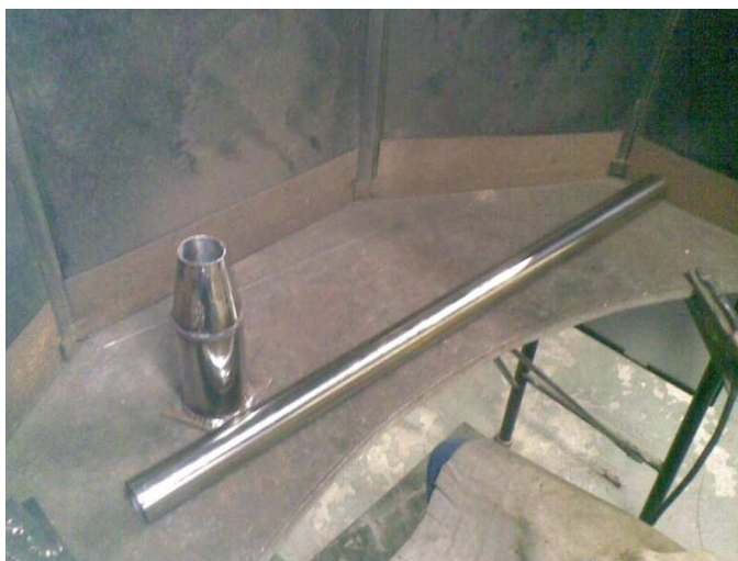
Fotografia 5 - Câmara de combustão e tubo de exaustão dos gases.
