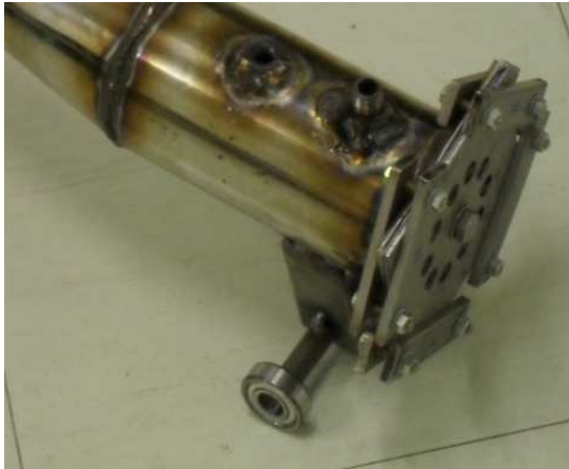
Fotografia 19 – Rolamento montado ao Motor.
