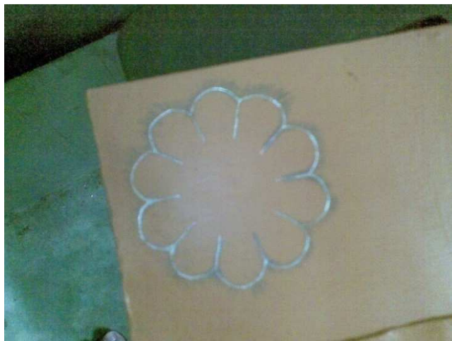
Fotografia 10 - Contorno da válvula na chapa de aço para fazer o ataque eletroquímico.
