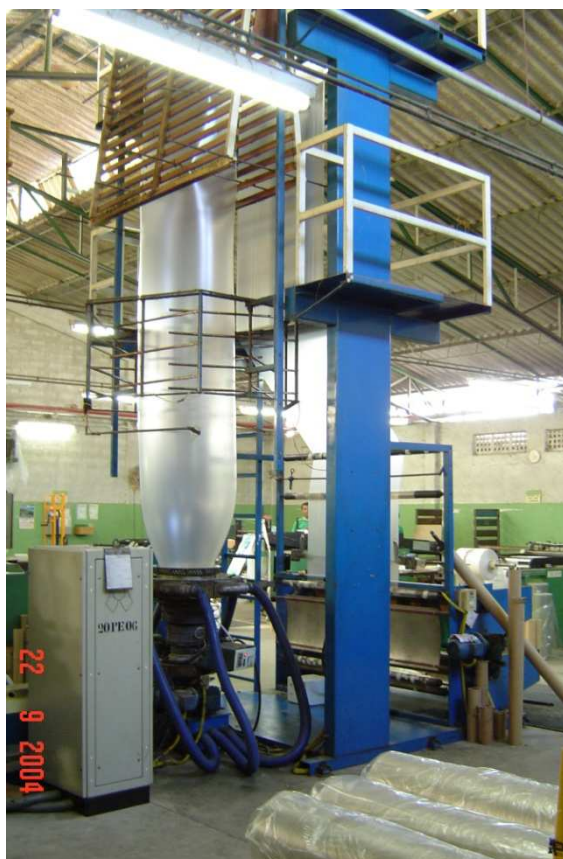
Figura 14: Máquina extrusora Fonte: Acervo da empresa
