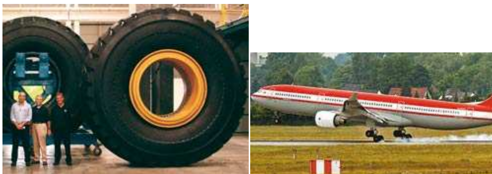
Figuras 8 e 9: Os pneus de aviação podem ser recauchutados até 11 vezes. O maior pneu de produção no mundo é o Titan International, Cada um custa U$ 50.000, e recauchutagem U$10.000 [16]
