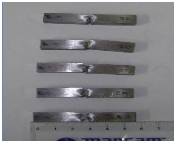
Figura 13 - Corpo de prova após ensaio de impacto
