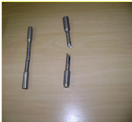
Figura 10 - Corpo de prova após ensaio de tração
