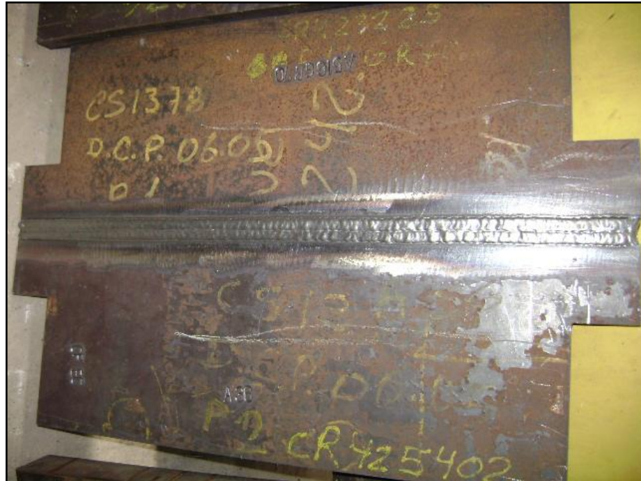
Figura 7 - Chapa soldada para extração de corpo de prova transversal
