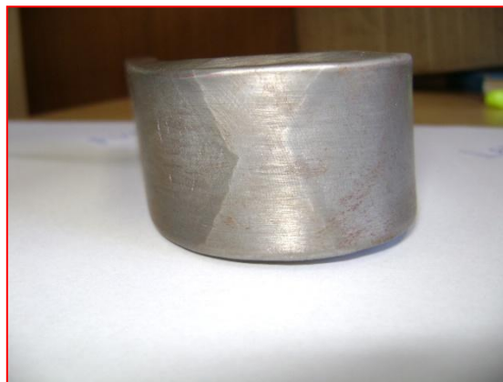
Figura 11 - Corpo de prova após ensaio de dobramento, evidenciando a inexistência de trincas
