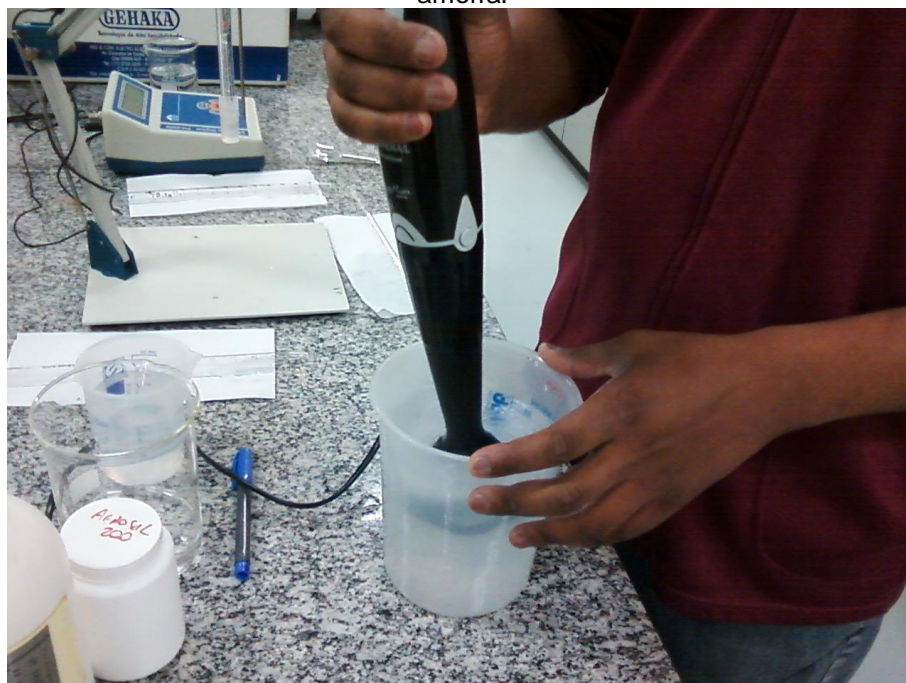
Figura 19 - Agitador rotativo de alta rotação, para quebra dos aglomerados de sílica pirogênica amorfa.
