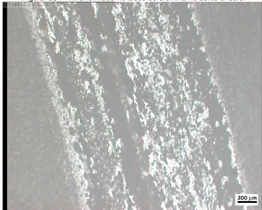
Figura 29 - Trilha formada no disco de alumina no sexto ensaio.
