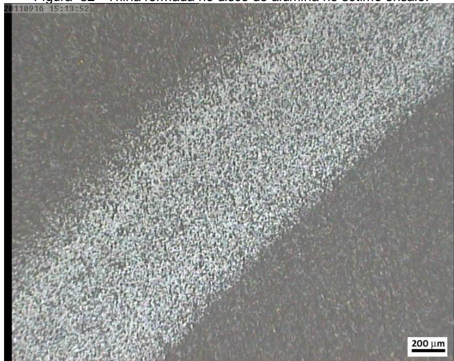
Figura 32 - Trilha formada no disco de alumina no sétimo ensaio.
