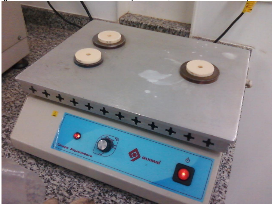
Figura 13 - Discos de alumina e de aço colados, resfriando sobre o aquecedor.
