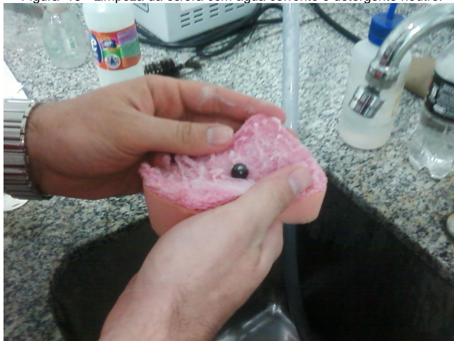
Figura 15 - Limpeza da esfera com água corrente e detergente neutro.
