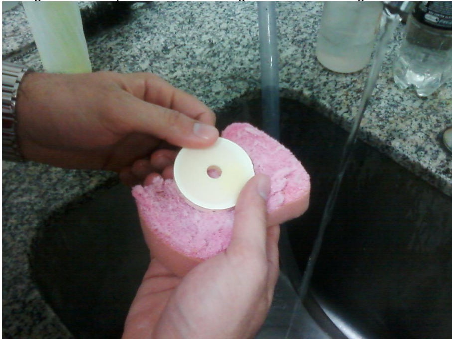
Figura 16 - Limpeza do disco com água corrente e detergente neutro.
