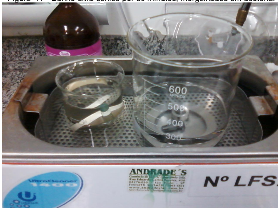
Figura 17 - Banho ultra-sônico por 30 minutos, mergulhados em acetona.
