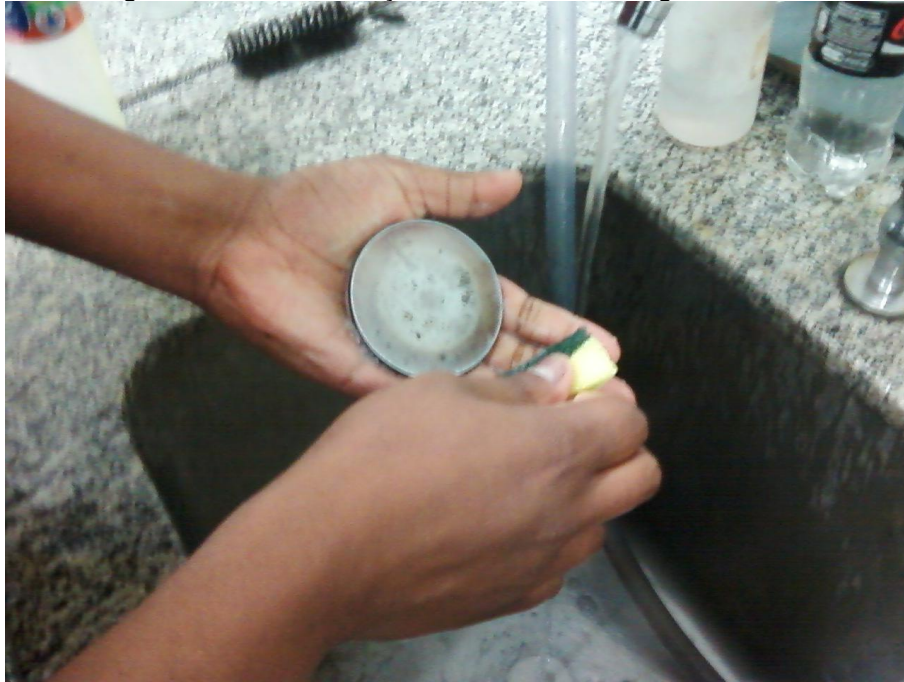
Figura 12 - Discos de aço sendo lavados em água corrente.
