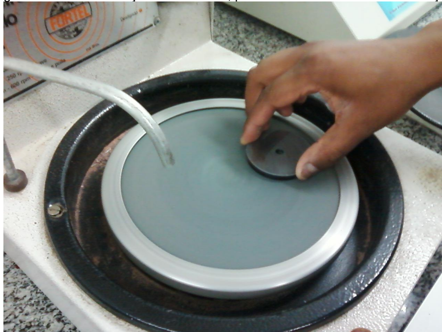
Figura 11 - Discos de aço sendo lixados, para retirada das marcas de oxidação.
