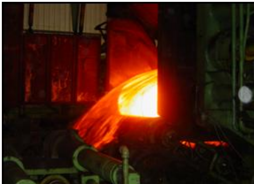
Figura 19: Foto no momento da quebra de carepas durante o bobinamento do esboço Fonte: AMT (2011).
