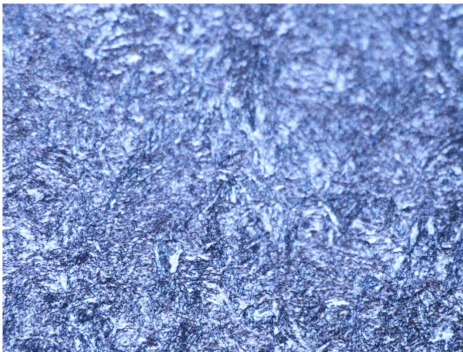
Figura 39: Superfície atacada com Nital 5% e com ampliação em 10000x no microscópio eletrônico nikon eclipse ma200 Fonte: Laboratorio de materiais/UFES
