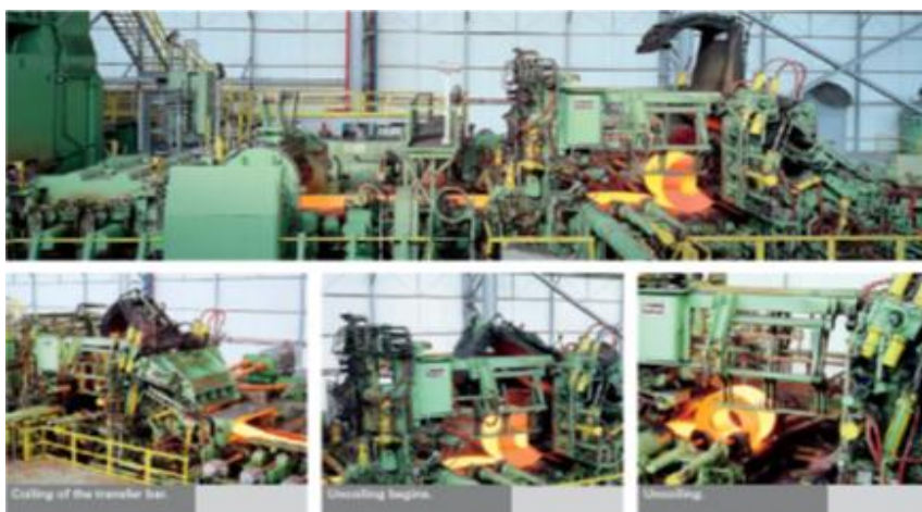
Figura 13: Sequência de transferência ativa, para bobinas de elevado peso. Fonte: AMT (2011).
