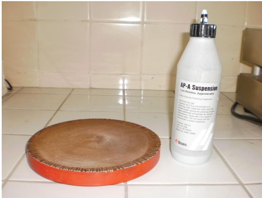
Figura 3.6 Pano para polimento de amostras metalográficas OP-NAP e alumina de 1 \mu\text{m}
