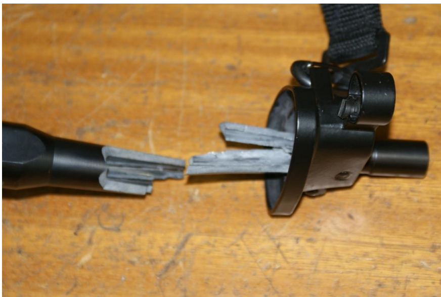
Figura 3.2 - Foto do cano fraturado da submetralhadora FAMAE .40.
