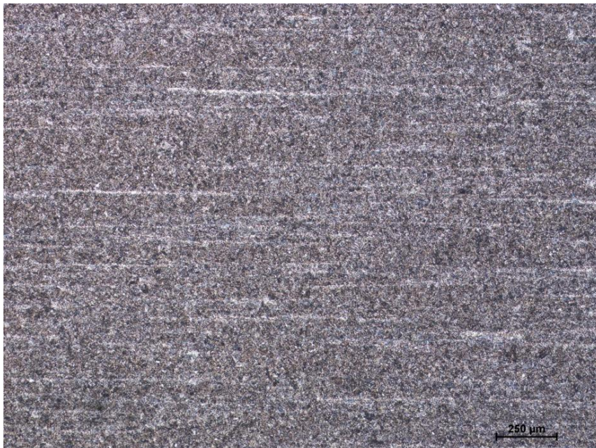
Figura 3.8 - Micrografia da região longitudinal do cano.
