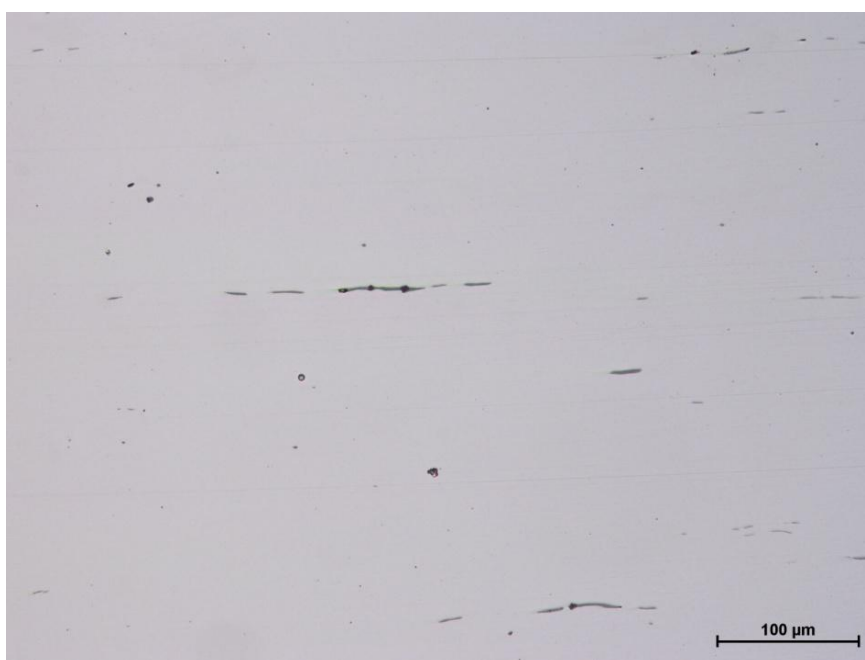
Figura 3.12 - Inclusões nodulares em corte transversal.
