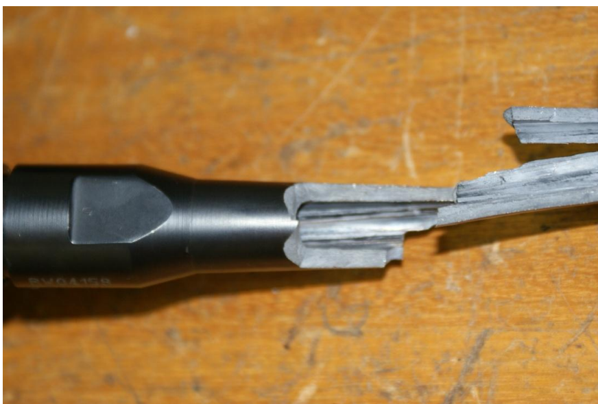
Figura 3.3 - Foto do cano fraturado da submetralhadora FAMAE .40.
