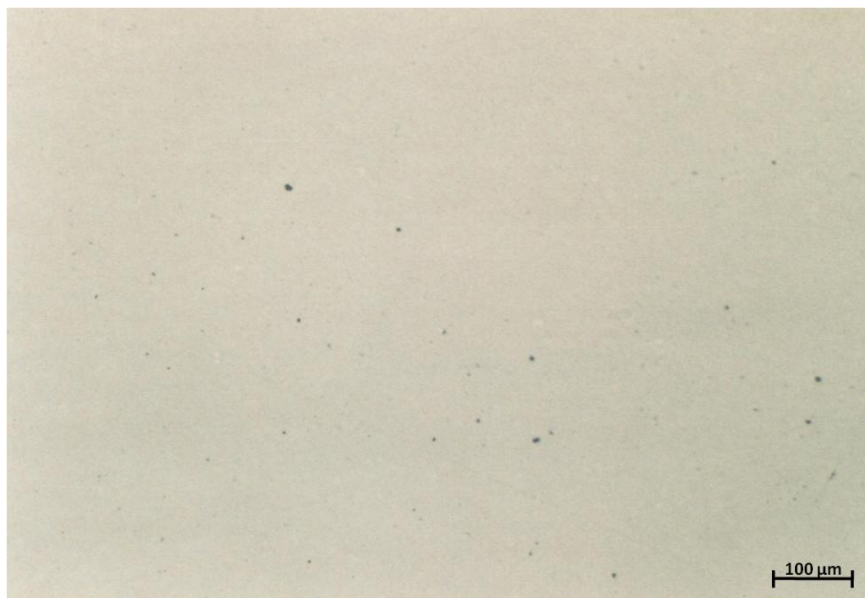
Figura 3.12 - Inclusões nodulares em corte transversal.
