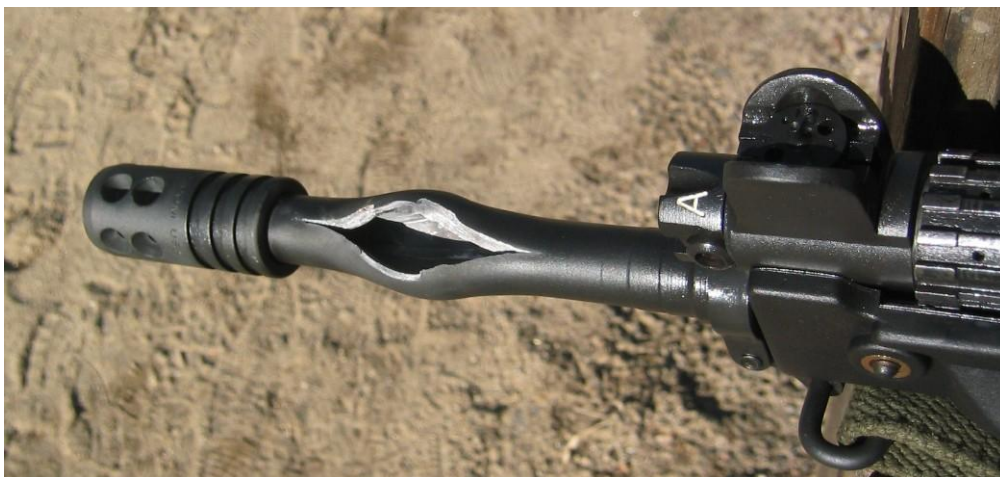
Figura 3.4 – Cano de fuzil com falha precedida por deformação.
