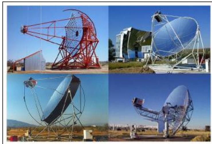
Figura 3.5 – Exemplos de coletores parabólicos.
