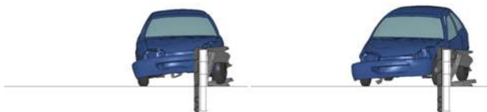
Figura 25: Teste TB11 do carro no momento do impacto.
