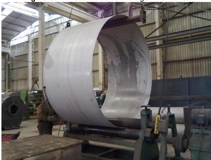
Figura 66 – Processo de calandragem na fábrica
