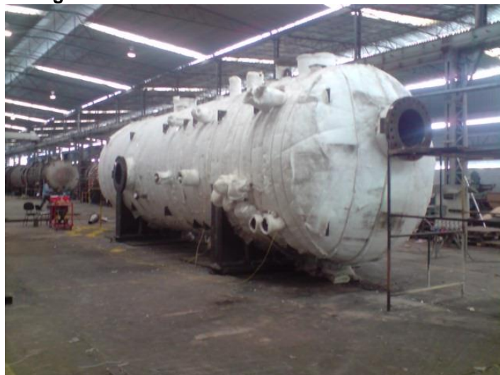
Figura 73 – Tratamento térmico realizado na fábrica
