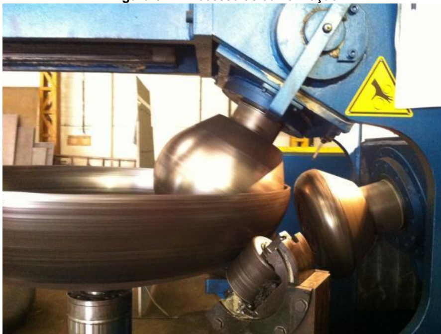
Figura 67 – Processo de conformação
