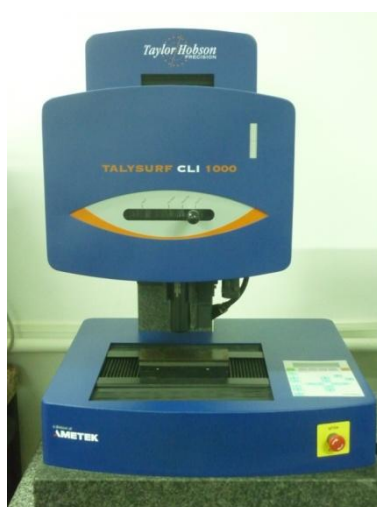
Figura 10 - Equipamento utilizado para realizar as análises topográficas das amostras
