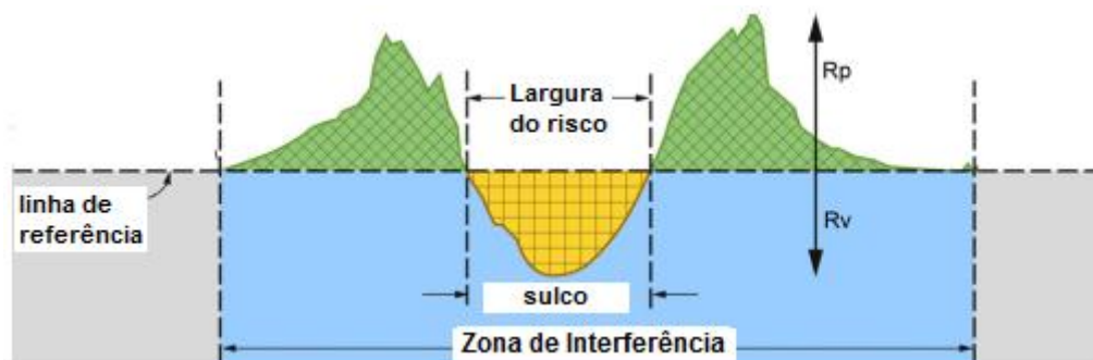
Figura 11 - Perfil do risco com a definição da zona de interferência [13]
