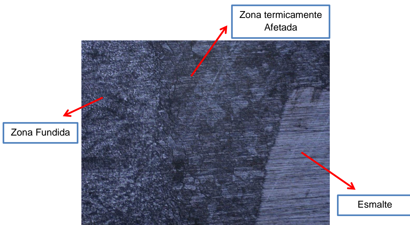
Figura 19: Micrografia Ótica da amostra D5, comparação ZF e ZTA.
