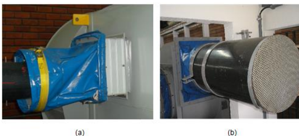
Figura 3.4 – (a) Detalhe da junção do plenum à tubulação de 8” com colarinho de lona e cinta da catraca; (b) Tela retificadora de fluxo instalada à jusante do rotor, na extremidade do duto de saída.
