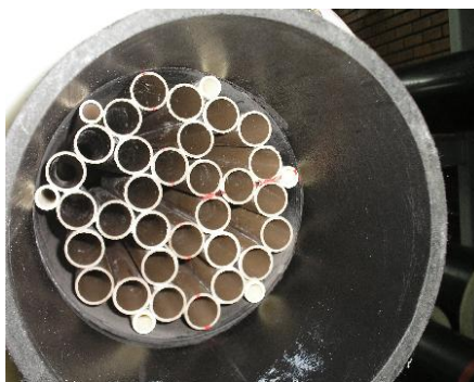
Figura 3.7 – Retificador de fluxo instalado em uma extremidade da tubulação.
