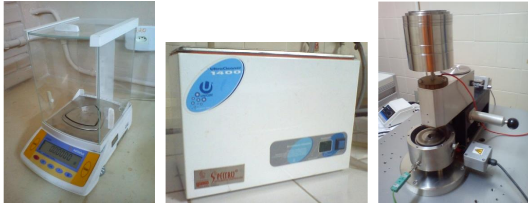
Figura a2 – À esquerda está a balança analítica, Sartorius CP 225 D, utilizada para verificar a variação de massa das amostras. Ao centro está o equipamento de ultrassom utilizado para limpeza das amostras. À direita está o tribômetro PLINT TE67 utilizado para os ensaios na configuração pino contra disco sem lubrificação.
