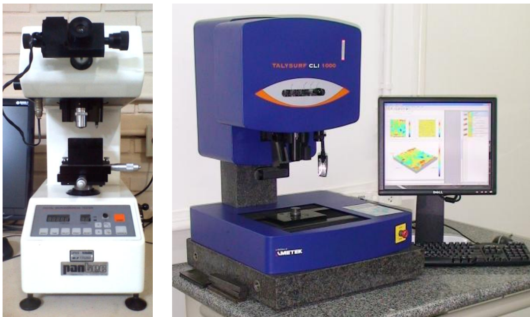
Figura a1 – À esquerda está o durômetro Vickers Pantec Metrologia Dimensional utilizado na caracterização da dureza das amostras. À direita está o analisador tridimensional Talysurf CLI 1000 utilizado para a caracterização das superfícies das amostras.
