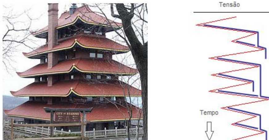
Figura 5.3 - Analogia entre o método Rainflow e o telhado Pagoda Fonte: Modificado de Wikipédia
