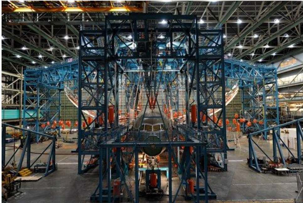
Figura 4-2: Ensaio de flexão das asas na unidade de teste estático do Boeing 787 Dreamliner. As asas aguentam cargas de até 150% do valor que jamais elas poderão passar durante o serviço operacional.
